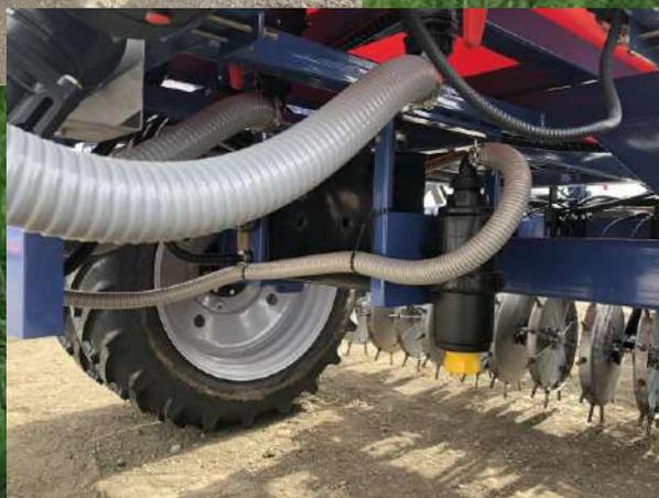
Третья ступень: магистральный фильтр, встроенный в блок управления системой внесения жидких удобрений.
