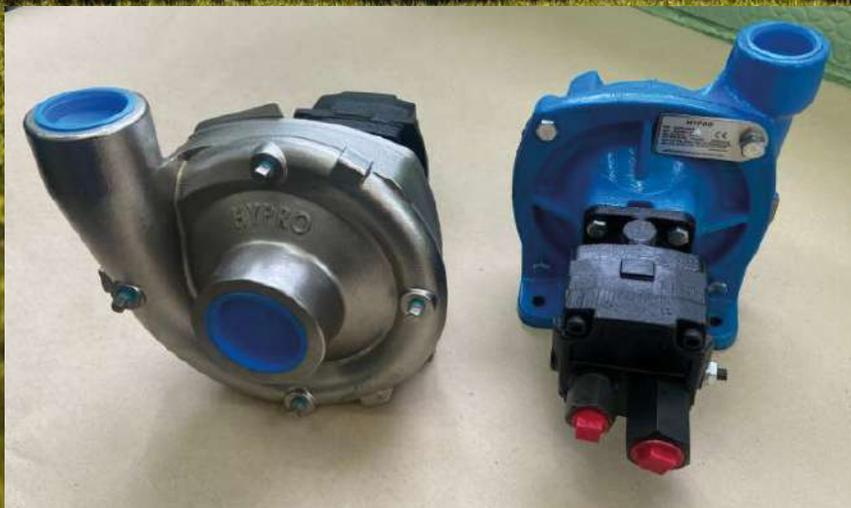
Подачу жидкого удобрения обеспечивает центробежный насос с гидравлическим приводом.
