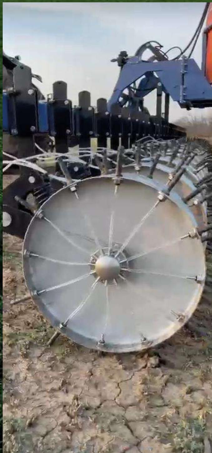
Инъектор корневой подкормки ИКП «ОСА» предназначен для внутрпочвенного внесения жидких удобрений посредством впрыска нормированной дозы в прикорневую зону растений на глубину 6-7 см., а также разрушение образовавшейся корки на почве путём частого прокола иглами инъекционного колеса осуществляя аэрацию почвы.
