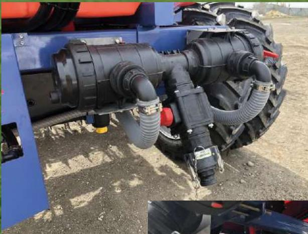
Вторая ступень: всасывающий фильтр перед центробежным насосом 400 л/мин. С постоянным перемешиванием удобрений в основном баке.
